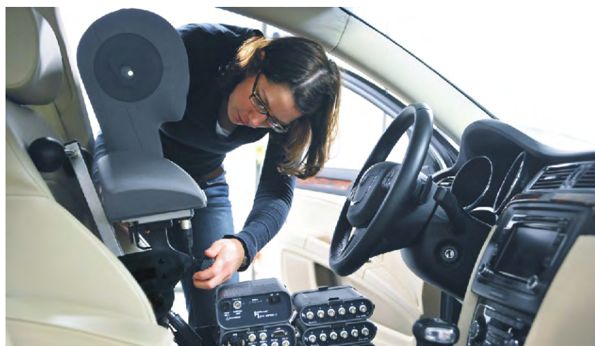
La HMS IV.1 peut se connecter directement sur le module de contrôle labCTRL 1.1 d'un système HEADlab. Le support de siège HSM V permet d'embarquer facilement l'ensemble du matériel et le fixer de manière sûre en véhicule.
