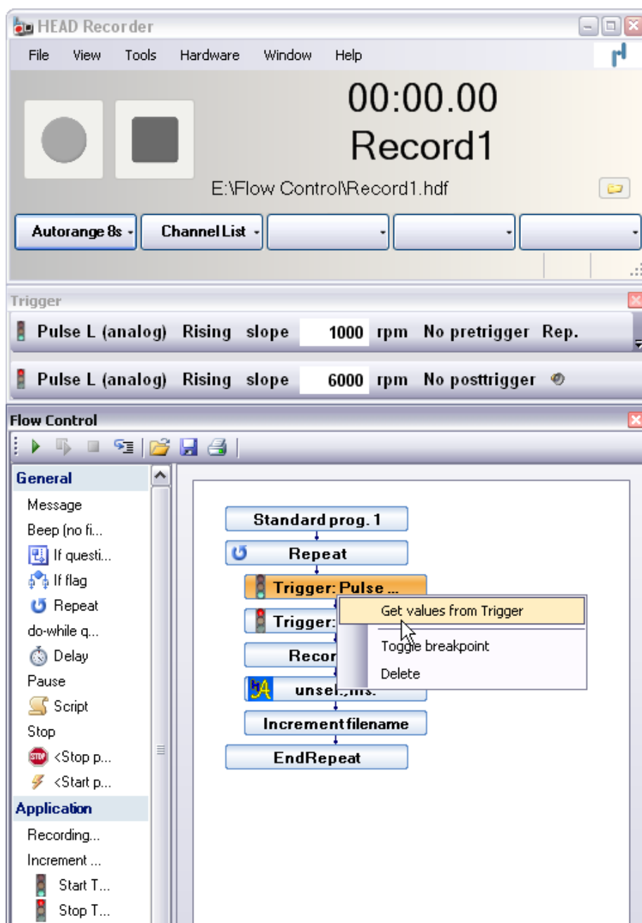
Figure 14 : Paramètres de trigger pour l'enregistrement d'une accélération
