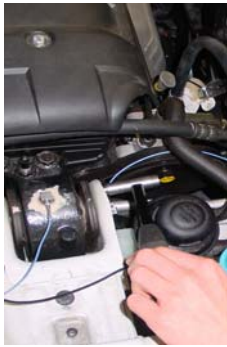
Fonction de transfert des paliers du moteur
