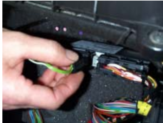
Figure 3: Démontage de la fiche mâle CAN existante
