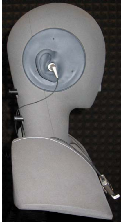
Intra-concha Handy-Headset in der anatomisch geformten Pinna (Typ 3.3) des Kunstkopfes HMS II.3
