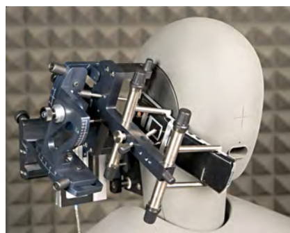
Kunstkopf-Messsystem HMS II.3 mit Handapparat-Positionierer HHP III für Messungen von Mobiltelefonen
