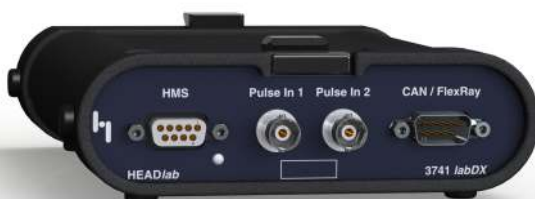
Digitalmodul labDX mit HMS-Anschluss, 2 Pulse- und 2 CAN-/FlexRay-Eingängen
